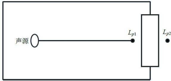
图 7-2 室内声源等效为室外声源图例
